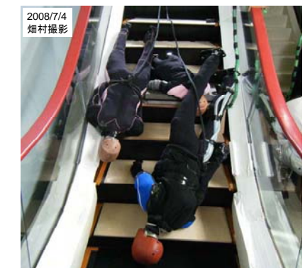
図8 下りエスカレータでの将棋倒し実験
