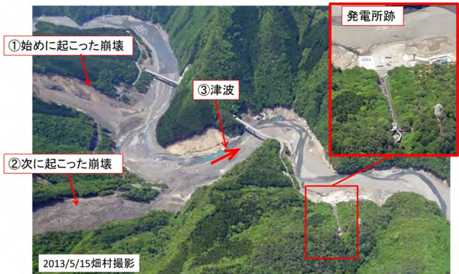
図19 十津川村・長殿地区の津波により破壊された長殿発電所跡[1]
