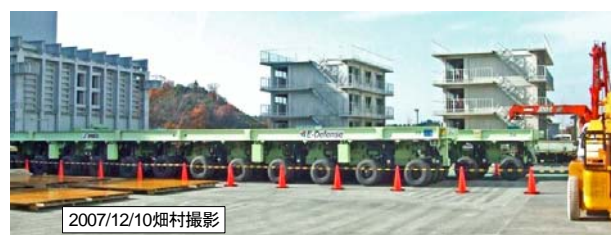
写真8 実大供試体を運ぶ多輪トレーラー
