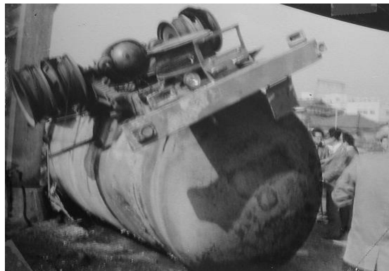
図2 横転したタンクローリ(後方から見る)
