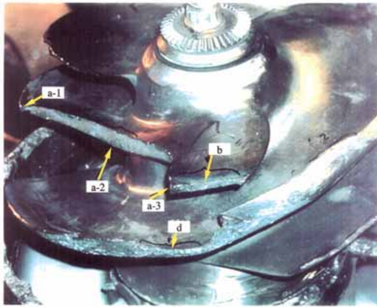
図5 インデューサ羽根の欠損
