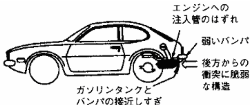
図1 1971年、1972年型フォード・ピントの構造欠陥 [1]
